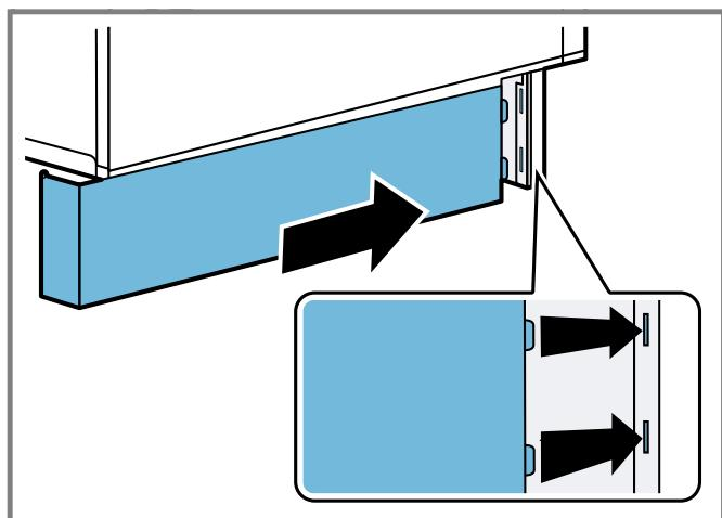
5. Fixez la plaque inférieure de protection droite/gauche à l'aide de la vis retenue.
