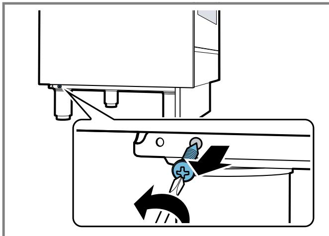
4. Prenez la bordure inférieure de protection du côté droit / gauche et faites-la pivoter afin d'insérer les languettes dans les fentes de la bordure inférieure avant.
