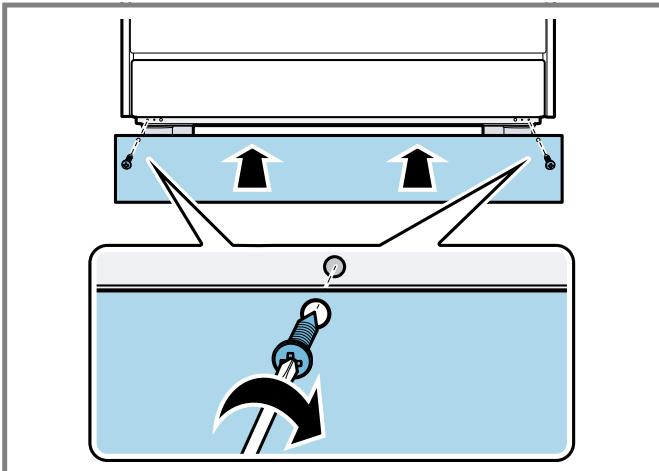
3. Retirez la vis illustrée dans le diagramme ci-dessous de chaque côté en préparation pour installer les supports de support de la bordure inférieure de protection gauche et droit.
