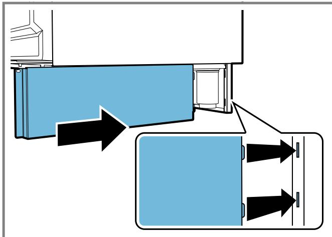
5. Fixez la bordure inférieure de protection droite / gauche à l'aide de la vis retirée à l'étape 3.
